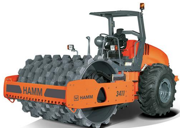
Кулачковый каток для грубого уплотнения связных почв весом не менее 20 тонн
